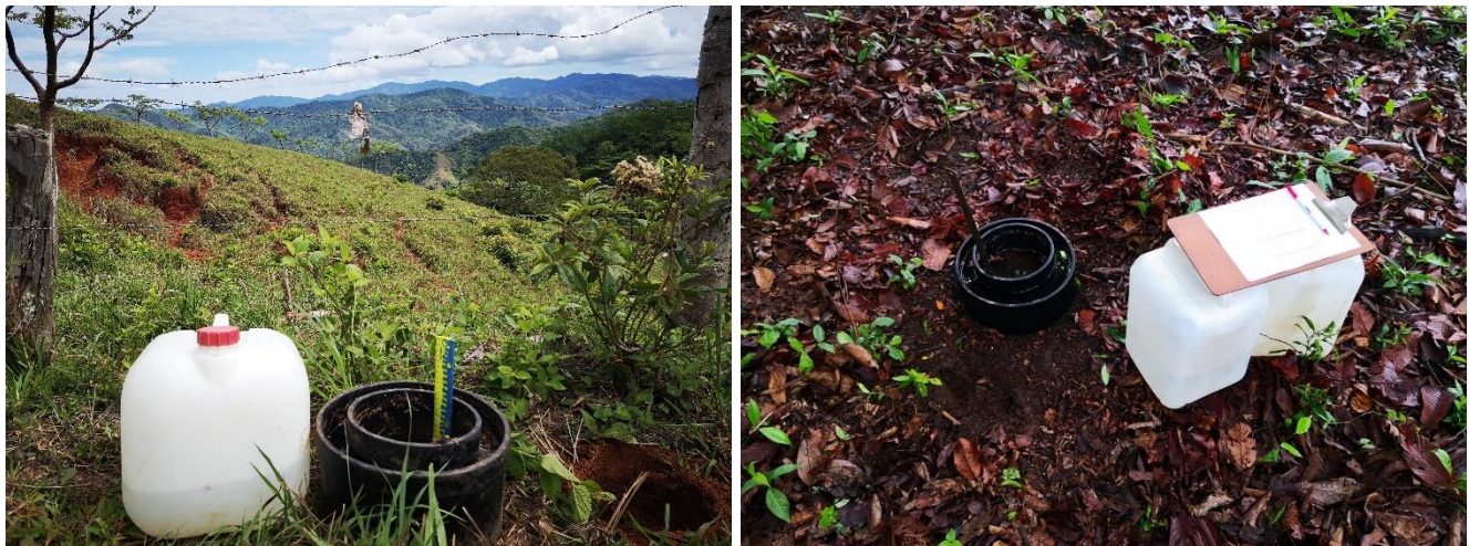
Figura 11. Ejecución de pruebas de infiltración mediante la metodología de doble anillo
